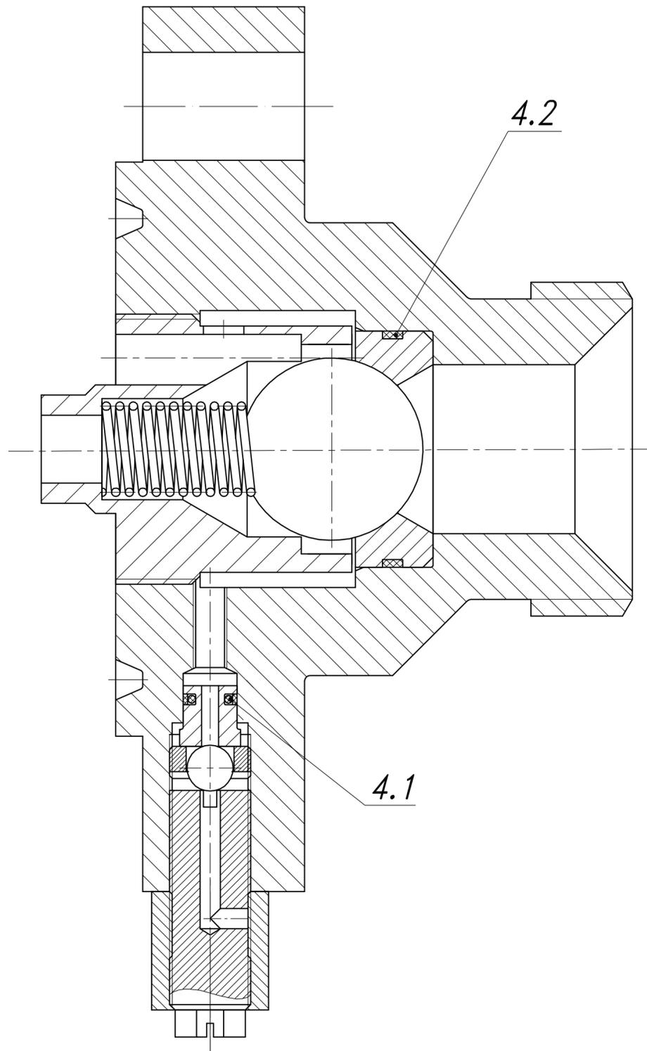
*Рисунок 4. Клапан обратный*
