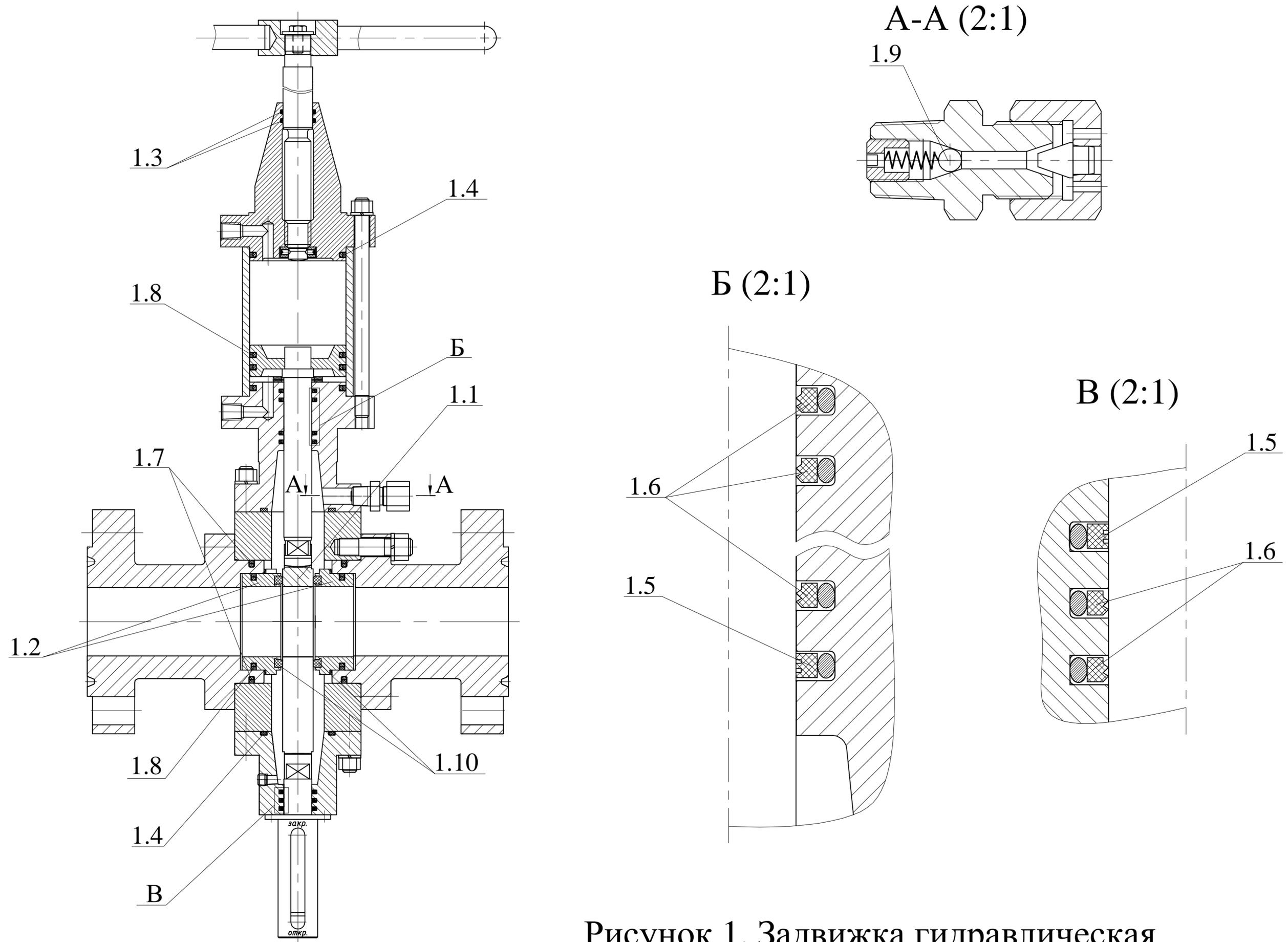
Рисунок 1. Задвижка гидравлическая
